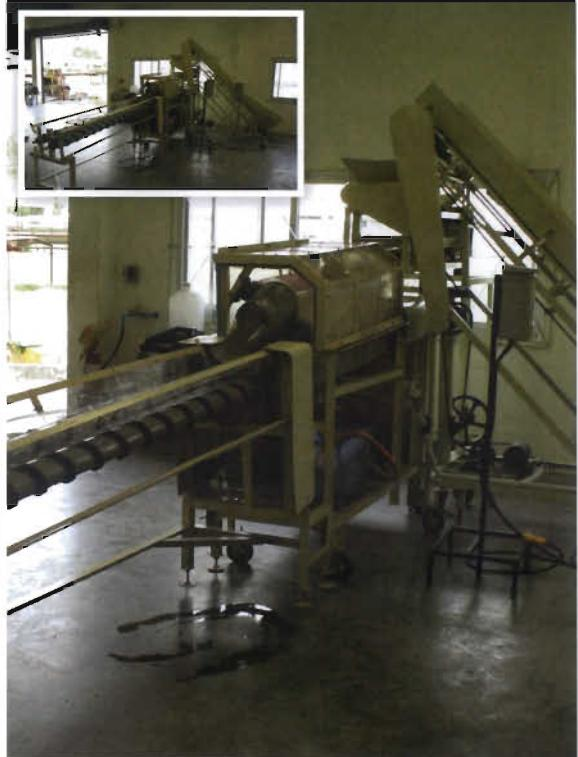
การล้างหน่อไม้ไผ่เพื่อตัดโดยการขัดบน เป็นการเพิ่มน้ำหนัก แต่กระบวนการล้างต้องใช้แรงงานคนมากและยุ่งยาก จึงได้สร้างเครื่องทำความสะอาดและคัดขนาดหันอไม้ไผ่ ให้อยู่ในระบบเดียวกัน โดยเริ่มจากการล้างเลียงหน่อไม้ท้าเกร่อง ส่งต่อส่วนทำความสะอาดโดยชุดคน และส่วนสุดท้าย คือ คัดขนาดได้สามขนาด คือ เล็ก กลาง และใหญ่ สามารถทำงานได้ 662 กิโลกรัมต่อชั่วโมง ทดแทนกระบวนการล้างคีม สามารถทำงานได้รวดเร็วกว่าแรงงานคนสองเท่า
